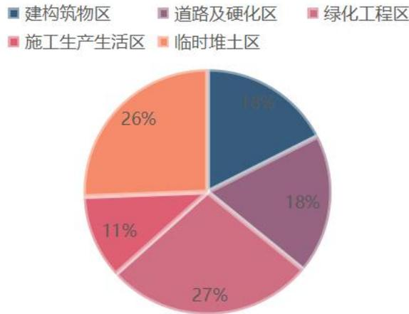
图 5.2-2 各工程单元新增水土流失量对比
